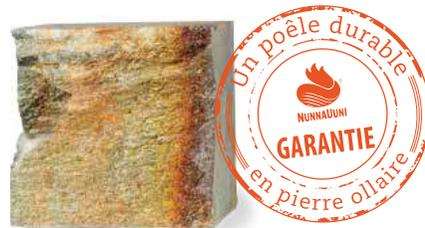
La couche de périclase qui se forme à la surface de la pierre ollaire Mammutti est le garant de la durabilité de la chambre de combustion.
